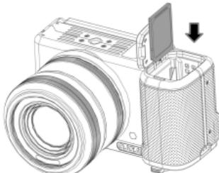
【依照图示方向笔直插入存储卡】
