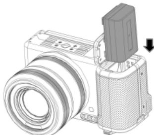
【依照图示方向将电池安装进摄像机】
