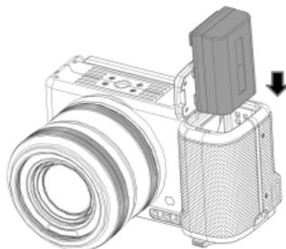
【Instalar la batería en la Cámara en la dirección mostrada en la imagen】
