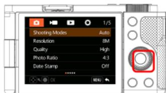
【 Appuyez sur **Le bouton d'exposition + Le bouton AFL** pour ajuster et accéder au menu paramètres du système 】
