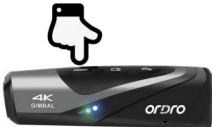
Wi-Fi 機能オン：ビデオカメラの電源ボタンを長く押し、電源オンにします。待機状態に入ります。電源ボタンを短く押します。青ランプが点灯し、「Wi-Fi 機能オン」との音声流れます。Wi-Fi 接続待ち状態に入ります。
